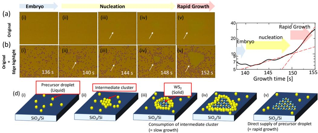
図 2:その場観測 CVD で観測した(a)オリジナル画像と(b)自動画像解析により結晶輪郭をハイライトした画像の成長時間発展の様子。(c)自動画像解析により抽出した単層  $WS_2$  結晶面積の時間発展プロファイル。(d)画像解析結果に基づく、単層  $WS_2$  の初期核発生機構概略図((i)液体前駆体が基板上を拡散、(ii)液体前駆体がクラスターを形成、(iii)前駆体クラスター内部から単層  $WS_2$  の核が発生、(iv)前駆体クラスター内部で  $WS_2$  成長が継続、(v)前駆体クラスターが全て消費され単層  $WS_2$  が成長)。
