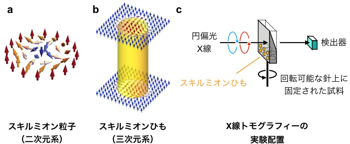
図1：(a)二次元系におけるスキルミオン粒子の模式図。矢印はスピンの向きを示している。(b)三次元系におけるスキルミオンひもの模式図。二次元的なスキルミオンが、ひも方向に一様に積層した構造を有している。(c)本研究におけるX線トモグラフィー実験の測定配置。さまざまな角度から観察した二次元 XMCD 透過像をもとに、図2・図3に示すようなスキルミオンひもの三次元形状の再構築を行った。
