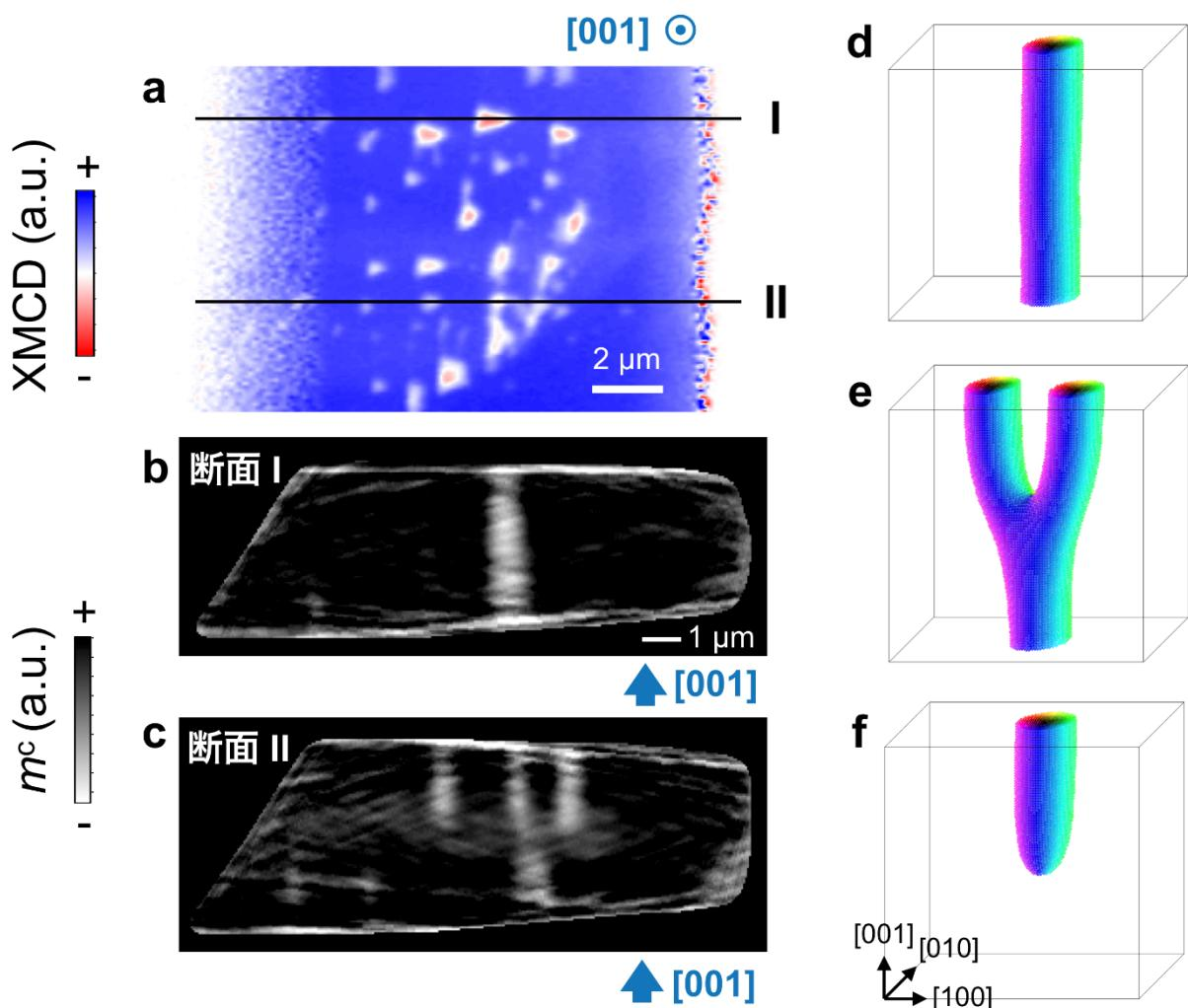
図2：(a) Mn<sub>1.4</sub>Pt<sub>0.9</sub>Pd<sub>0.1</sub>Sn合金におけるスキルミオンひもを、真上から観察した二次元XMCD透過像。背景色はXMCD強度を表しており、X線入射方向のスピン成分を反映している。(b),(c)トモグラフィー測定から再構築された[001]スピン成分( $m^c$ )の三次元空間分布の断面図。(b)では試料の端から端までスキルミオンひもが貫通しているのに対して、(c)では途中で切れたりY字に分岐したりといった欠陥構造が存在することが読み取れる。(d)-(f)理論計算によって得られた、スキルミオンひものさまざまな形状の例。
