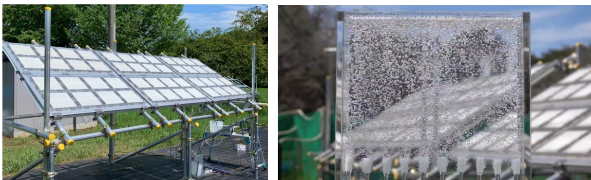
図4 3 m 2 スケール光触媒パネルモジュール（左）と100 m 2 スケール光触媒パネル反応器から生成する水素酸素混合気体（右）
