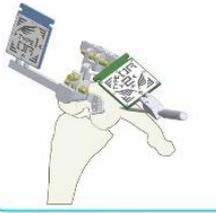
ARマーカ付ポイントプローブにて大腿骨内上顆、外上顆をプロットし、算出された上顆軸中心点と大腿骨頭中心点を結ぶ大腿骨機能軸を算出します。
