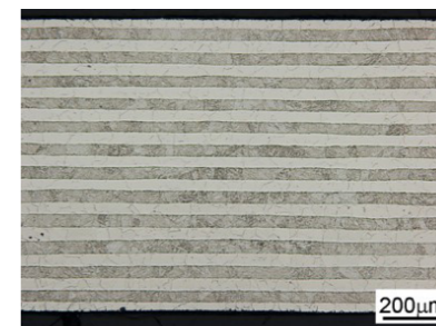
■開発した複層鋼板の断面観察（光学顕微鏡）
