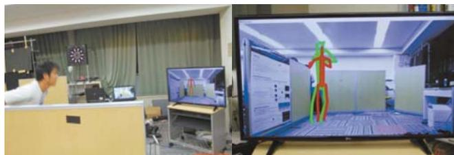
図2: ジャンプ直前の骨格情報からその後の動きを予測する装置
