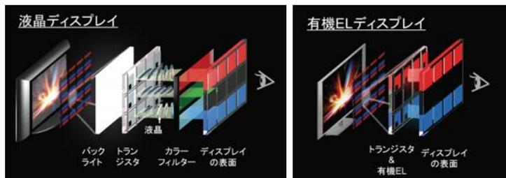
図：液晶と有機ELの構造(作成：岡本 敏宏先生)
