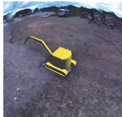
図3:ショベルカー自体に複数搭載されたカメラの画像から再現された疑似俯瞰画像。複雑な地形を俯瞰することで、操作を容易にできる。
