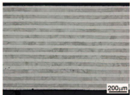
図1：強さと伸びを両立した複層鋼板の断面
