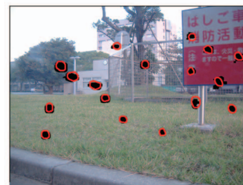
図2 水滴の付いた画像（上）と3次元計測の結果（中）から水滴の位置を推定（下）
