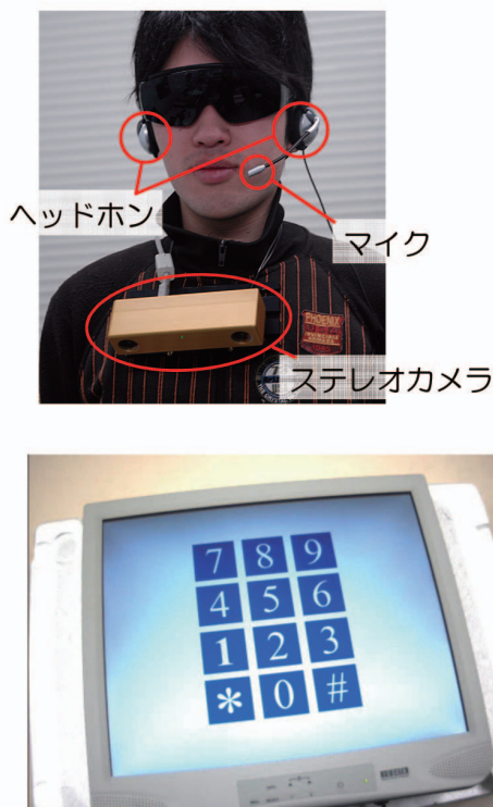
図3 目の不自由な人のためのタッチパネル操作支援技術。押したいボタンをマイクで伝えると、カメラが指先とボタンの位置関係を計算しヘッドホンからの音声で誘導してくれる
