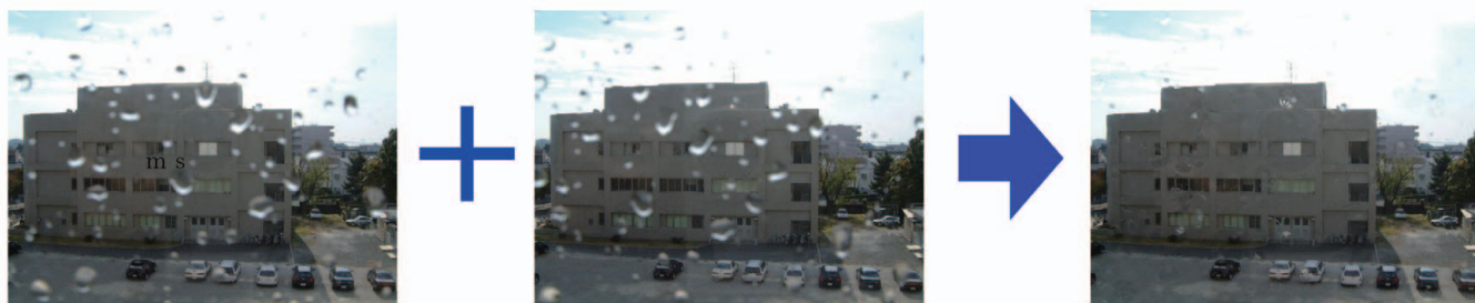
図1 画像処理による視野明瞭化の例。異なるカメラで撮った複数枚の画像（左、中）の水滴のない部分を合成し、水滴のない画像（右）を作る
