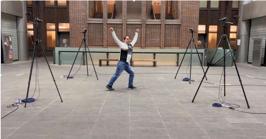
【写真1】ビデオモーションキャプチャ（カメラ4台@120FPS）
