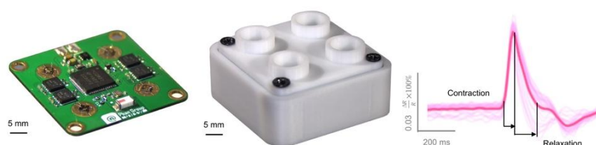
図1：ミニ心臓の拍動をワイヤレスで読み取るウェルプレート型センサー
