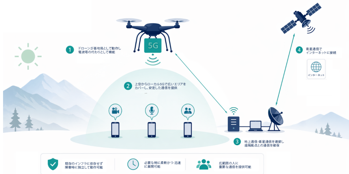
図 2 ドローン×ローカル 5G×衛星通信による新たな通信システム
