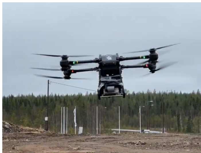
図 1 ドローン搭載型ローカル 5G 基地局
