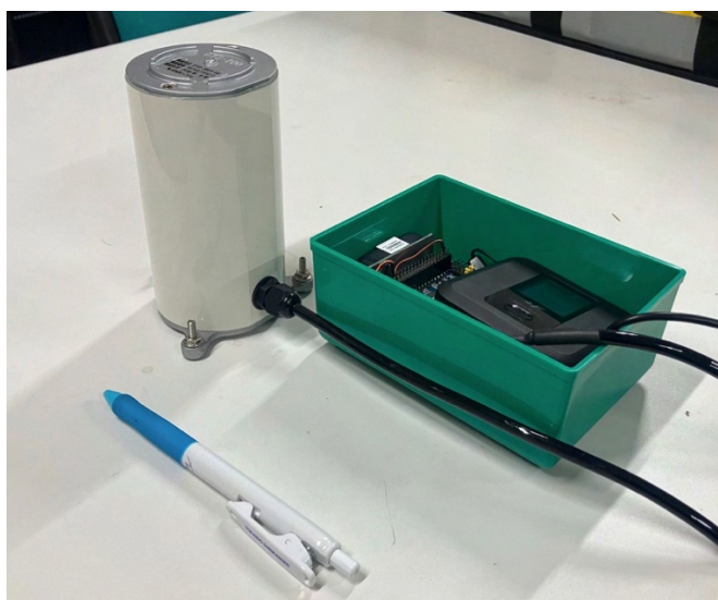
図2：リアルタイムデータ転送・人流モニタリングを可能とした地震計の写真
