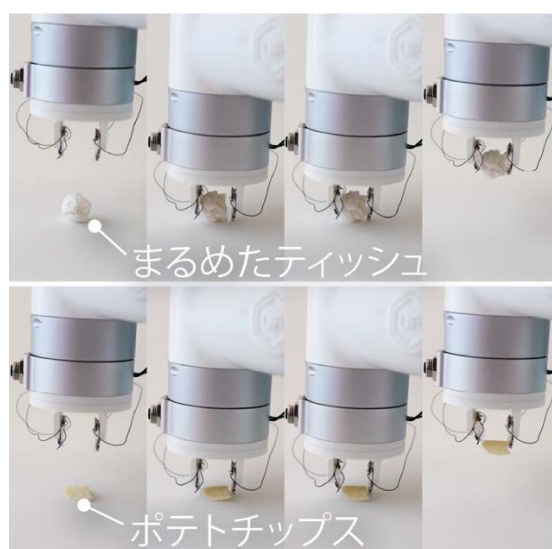
図2：液体相変化パウチアクチュエータによる繊細なものをつかむ動作
