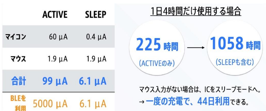
図 4：指輪型無線マウスの概要と動作時間
