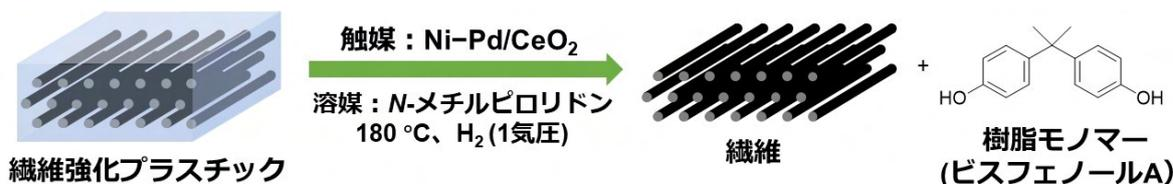
図 1 : Ni-Pd/CeO<sub>2</sub> による繊維強化プラスチックの分解
