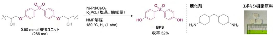
図 3 : Ni-Pd/CeO<sub>2</sub> 触媒によるエポキシ樹脂の加水素分解
