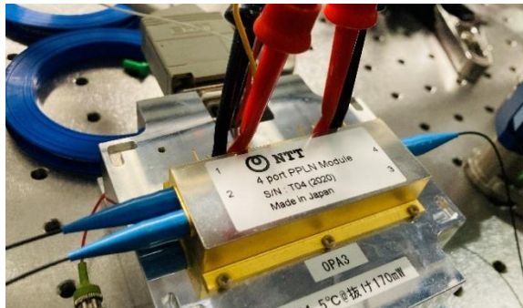
図 1：今回の実験で用いた光パラメトリック増幅器（左）とモジュール内部の概念図（右）
