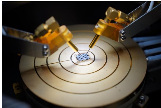
AIN 系 SBD の電氣的特性の測定の様子
