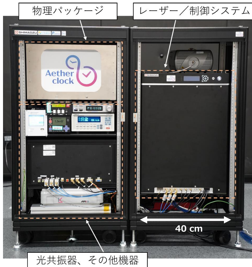
図5 19インチラックに組み込んだ250リットル光格子時計 開発した超高精度小型光格子時計装置。レーザー冷却された原子を光格子中に捕獲し、低温に冷却した恒温槽の中で時計遷移を高精度に分光する。時計分光用真空槽を含んだ物理パッケージ、光共振器、レーザー／制御システムを搭載している。
