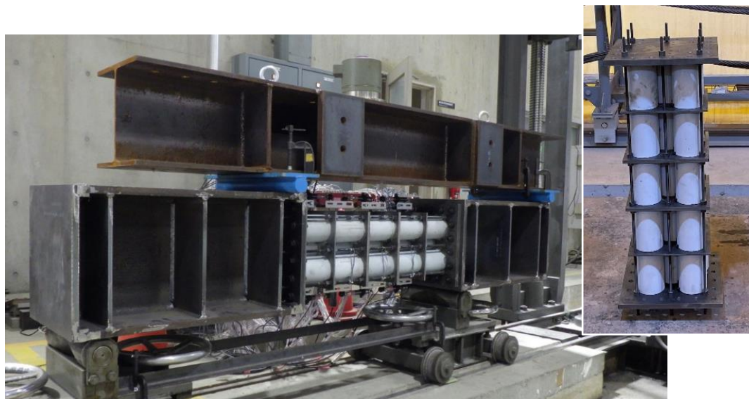
図 4：CCC 柱部材の耐震性評価試験
