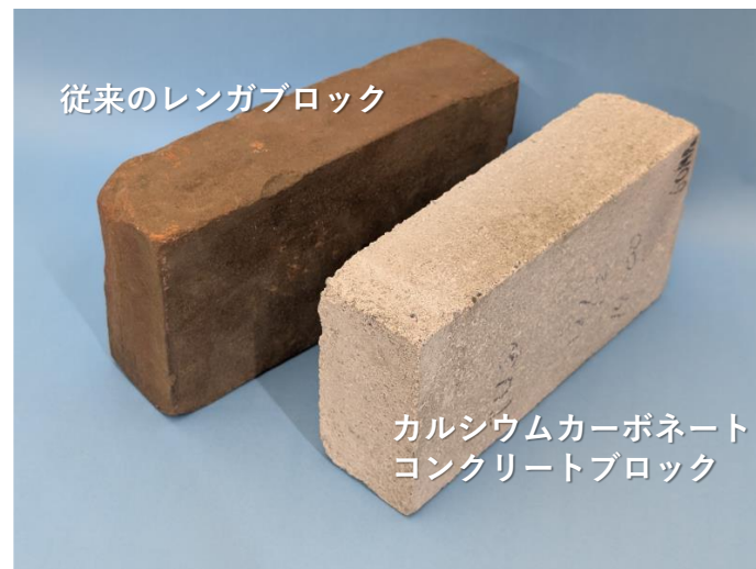
新手法で製造されたカルシウムカーボネートコンクリートブロックと従来のレンガブロック
