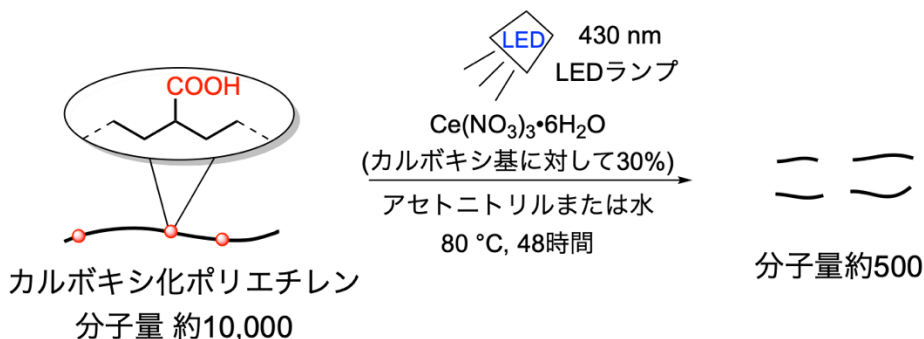
図6：セリウム触媒によるカルボキシ化ポリエチレンの光分解反応
