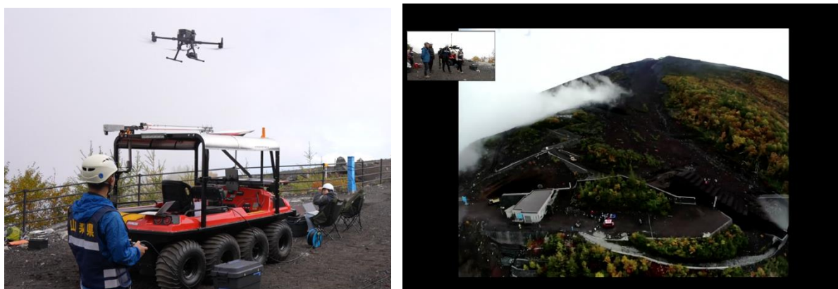
図1：ローカル5Gを利用したドローンからの映像伝送実験（注2）
