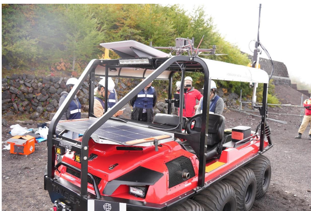
図2：低軌道衛星通信・ドローンを搭載した迅速移動・展開可能なローカル5G基地局（注3）
