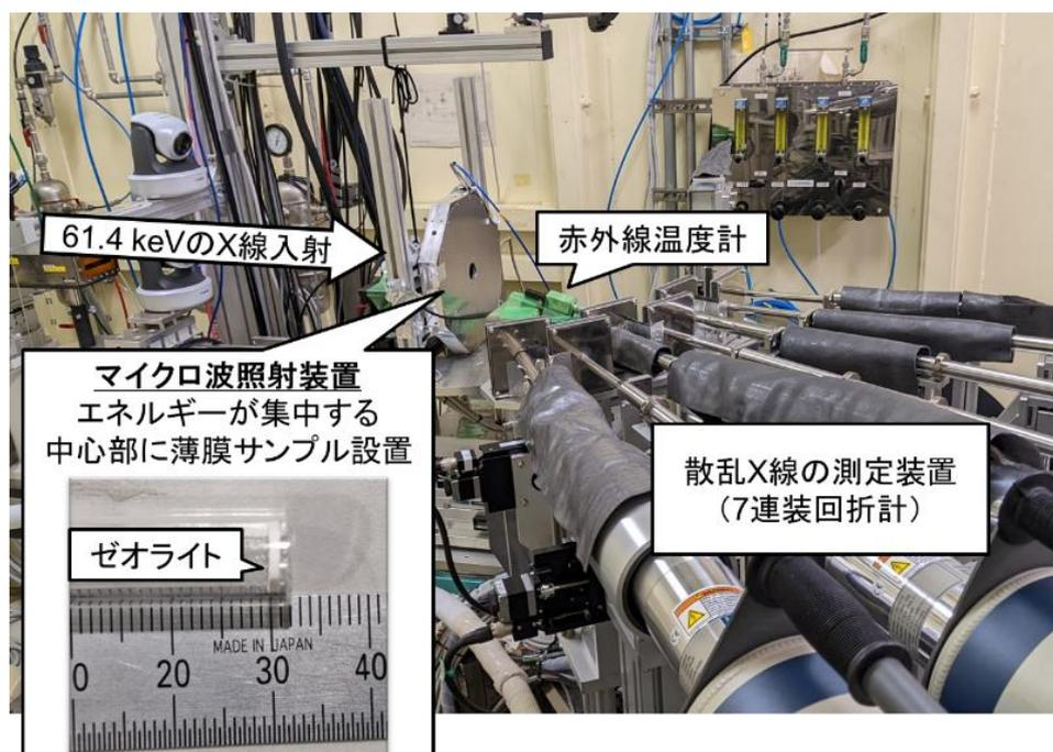
図2：マイクロ波照射その場での高エネルギーX線全散乱測定の様子
