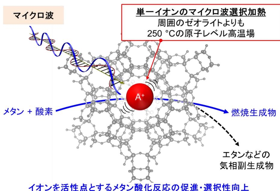
図1. マイクロ波で選択加熱されたゼオライト細孔内イオンのメタン酸化反応
