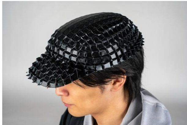
お湯につけるだけで平面から立体へ自動変形した帽子
