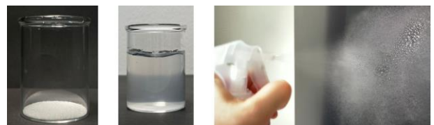
図3(左)開発した CNF パウダー(中)水に加えると無色透明な液体(右)霧吹きしても液だれしない
