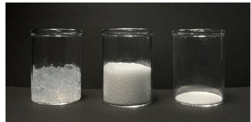
図7 同じ CNF 重量のサンプル。(左)体積の9割以上が水となる CNF ペースト(中)体積の9割以上が空気となる CNF パウダー(右)開発した CNF パウダー
