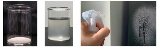
図4(左)110℃オーブン乾燥で作製した CNF パウダー(中)水に加えると水は白濁不透明になる(右)霧吹きすると液だれする
