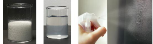
図5(左)凍結乾燥で作製した CNF パウダー(中)水に加えると無色透明な液体になる(右)霧吹きしても液だれしない
