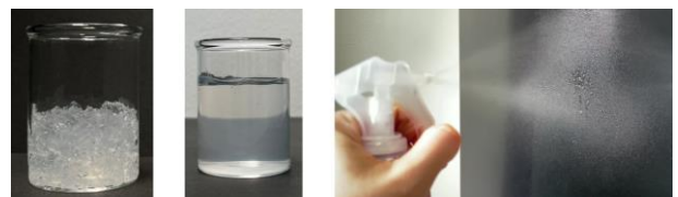
図 2(左)CNF ペースト、固形分濃度 2%(中)水に加えると無色透明な液体(右)霧吹きしても液だれしない
