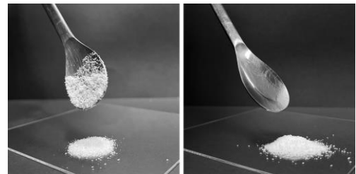
図6(左)凍結乾燥で作製した CNF パウダーは、静電気によって色んなところに付着する(右)我々の CNF パウダーは、帯電の影響を受けず、ハンドリングが容易である
