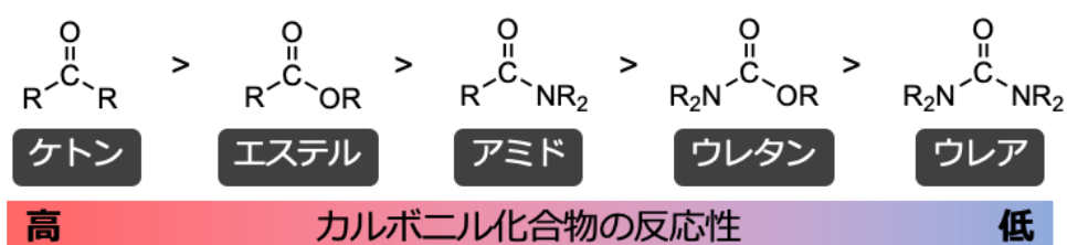
図1：カルボニル化合物の反応性の一般的な序列
