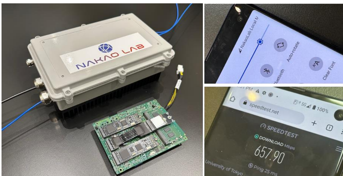
図 1：今回開発したローカル 5G システム (左画像の上)
