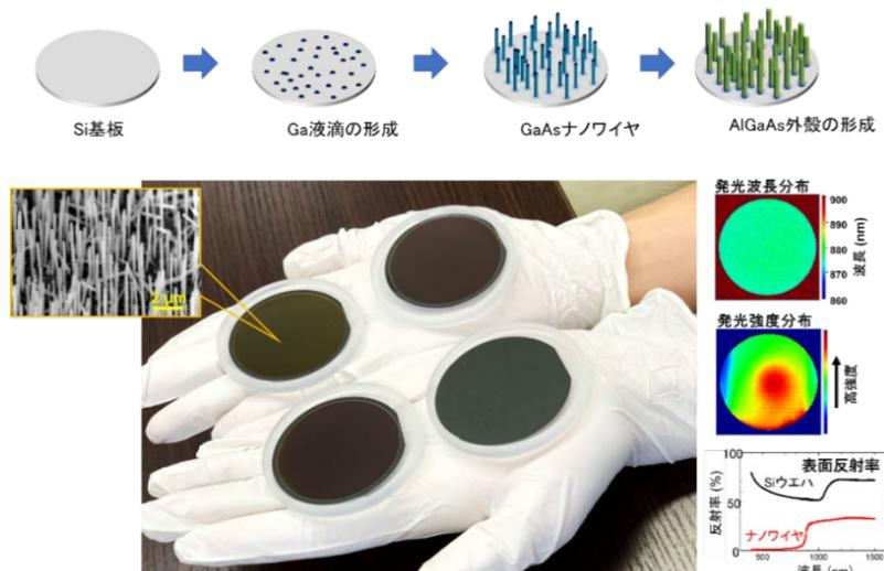
シリコンウエハ全面にナノワイヤを形成した試料。ナノワイヤが均質に形成され、光特性の高いガリウムヒ素基板相当以上の強い発光がウエハ全面で観測される。光吸収のため見た目は黒くなる。
