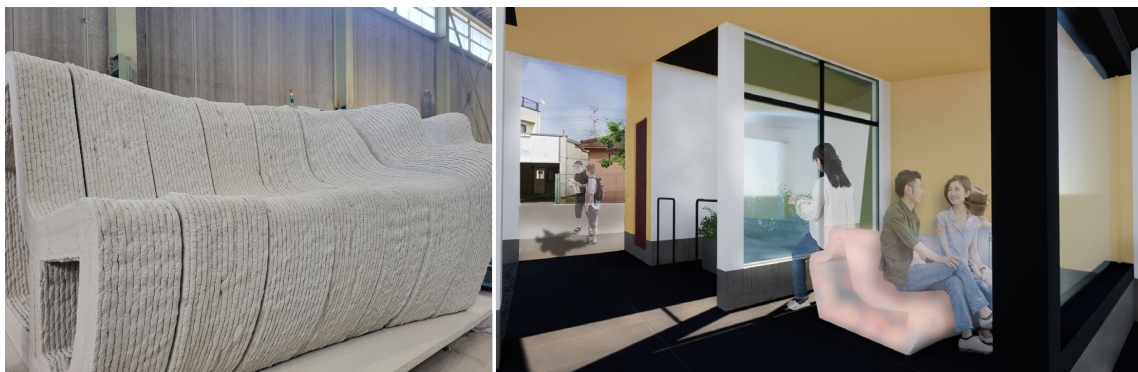
図3：會澤高圧コンクリートによる内ベンチのテストプリント
