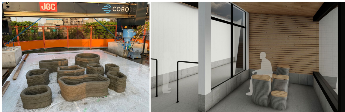
図6：日揮グローバルによるベンチのテストプリント
