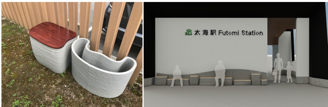
図5：クラボウによるベンチのテストプリント
