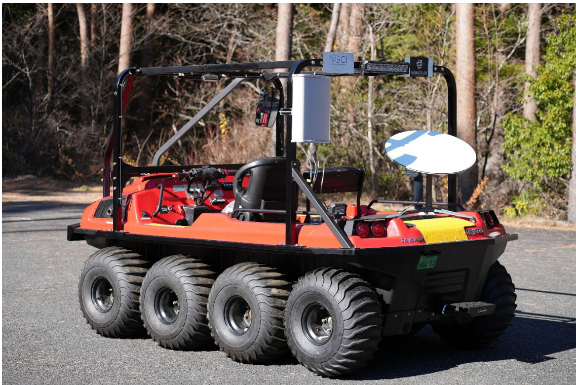
図2 8輪バギーへローカル5G、衛星インターネットアクセスサービスを搭載した有事の復旧、減災活動での情報通信網の運用コンセプトモデル
