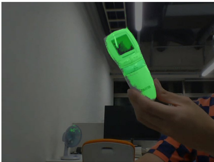
図 1. LookHere システムのインターフェース。ユーザが AI モデルに学習させたいと思う物体をカメラの前に提示すると、ユーザの教示動作を基に AI モデルの学習に使うべき物体の領域を推定し、この図のようにユーザに提示する。ユーザは緑色のハイライトが学習させたい物体の上にあることを確認し、撮影を行う。これにより、ユーザは画像中のどの部分が AI モデルの学習に特に使用されるかをデータ収集時に確認することができ、信頼性のある AI モデルの構築を追加の負荷（手作業でのアノテーション等）なく実現できる。
