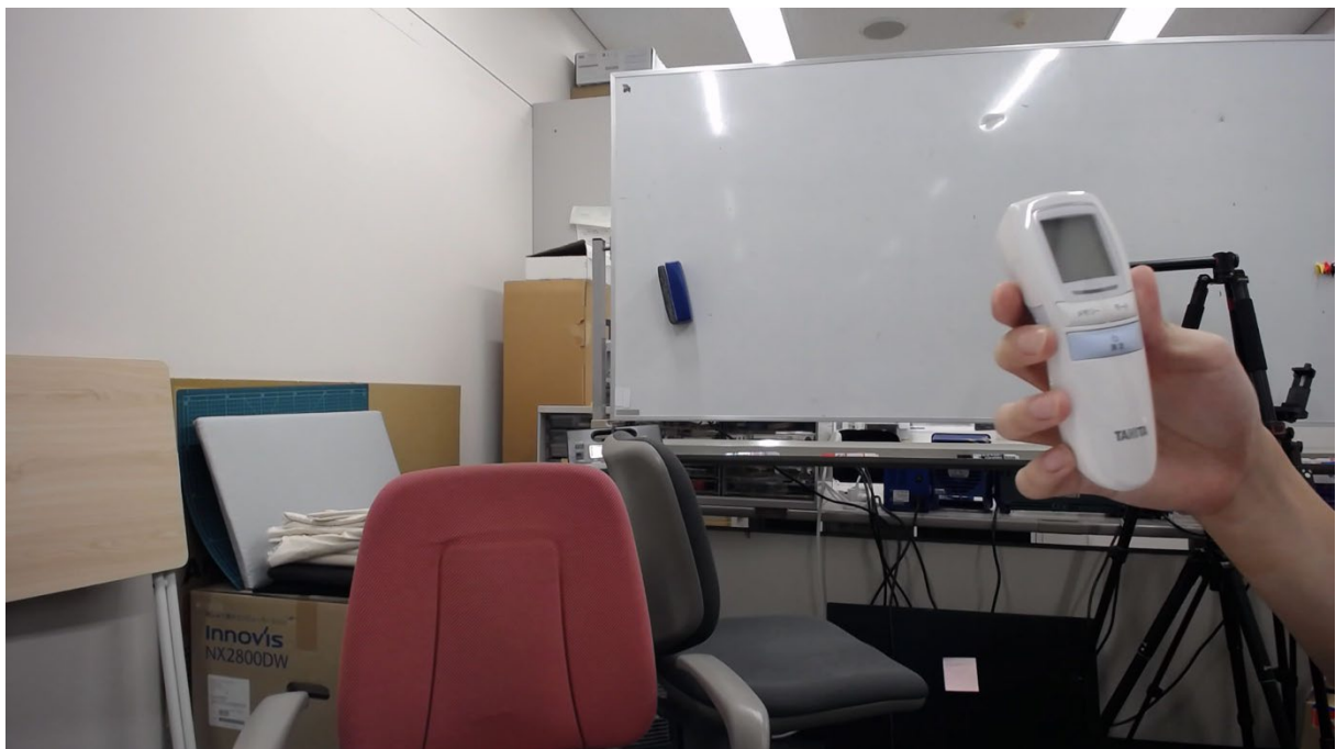
図 2a. 非接触式の体温計を認識させるためにカメラに提示しているところ。
