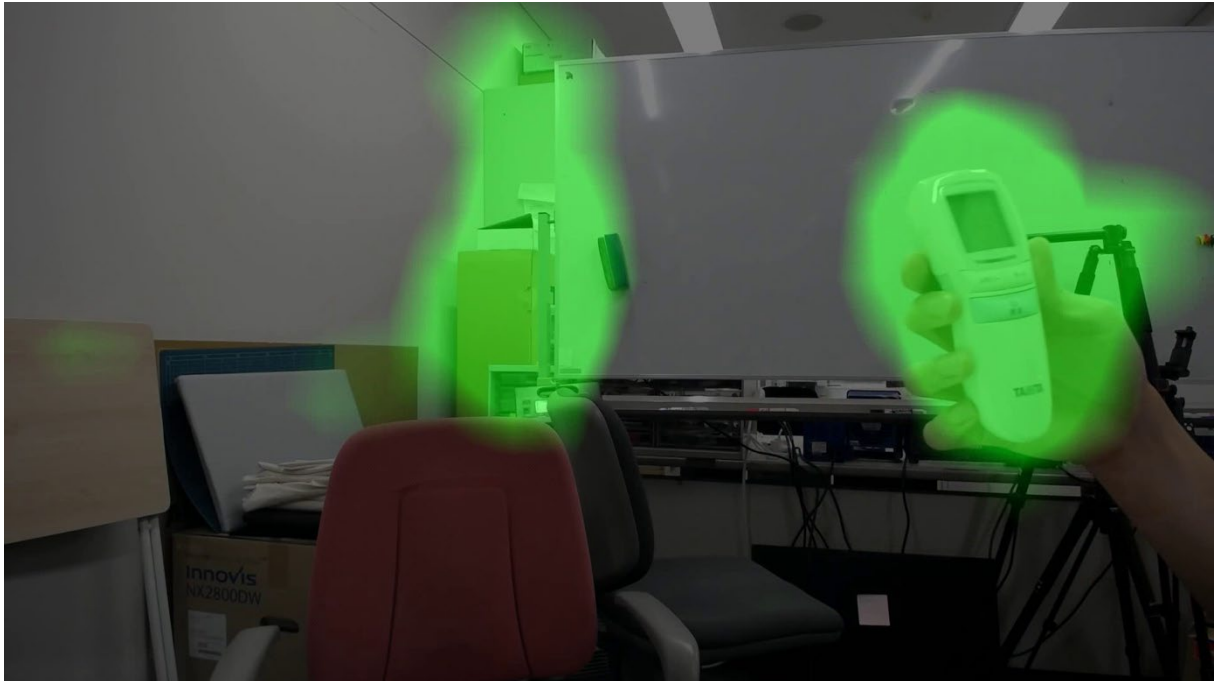
図 2b. 図 2a と同じ画像において、LookHere を使用しない場合に AI モデルの学習において、特に使用された部分を緑色でハイライトしたもの。非接触式の体温計の部分以外にも、背景にある三脚や棚、ホワイトボードなど、無関係な部分も学習に使用されている。このため、例えば違う背景で同じ AI モデルを使用した場合、想定通りに認識しない可能性がある。
