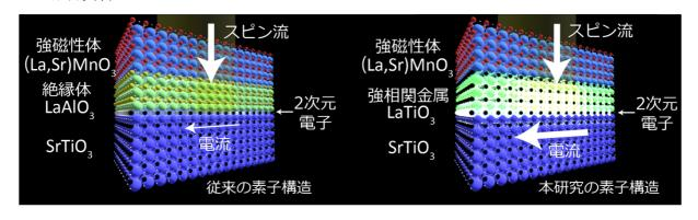
図(左)従来の研究で使われてきた素子構造の例。(La,Sr)MnO<sub>3</sub>/LaAlO<sub>3</sub>/SrTiO<sub>3</sub> を用いて、スピン流を LaAlO<sub>3</sub> と SrTiO<sub>3</sub> の界面に形成されている 2 次元電子ガスに注入すると、スピン流が電流に変換される。スピン流が絶縁体である LaAlO<sub>3</sub> で減衰するため、効率的なスピン流注入は難しい。(右)今回用いた(La,Sr)MnO<sub>3</sub>/LaTiO<sub>3</sub>/SrTiO<sub>3</sub> 構造。スピン流が強相関金属である LaTiO<sub>3</sub> をスムーズに流れるため、高効率のスピン流電流変換が実現できる。
