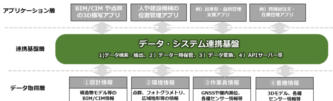
図1 データ・システム連携基盤を活用した施工管理システム全体図
