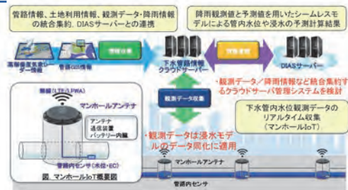
都市浸水リスクの管理・制御のためのIoTを活用した管内水位センシング技術
