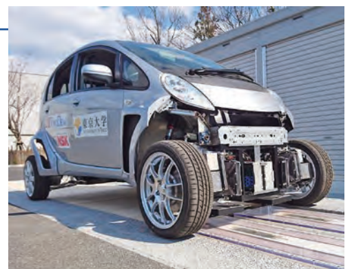
路面に埋められたコイルからインホイールモータへ走行中にワイヤレス給電できる電気自動車
