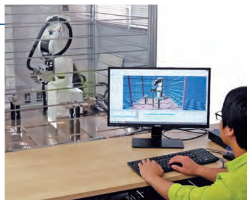
モノづくりにおける課題解決を目指した取り組みの一つである、ロボットによる部品組付けのシミュレーション
