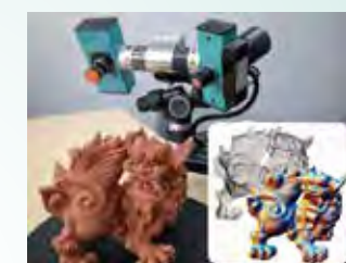
3Dスキャニング技術による実物形状のデジタル化
