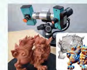
3Dスキャニング技術による実物形状のデジタル化
