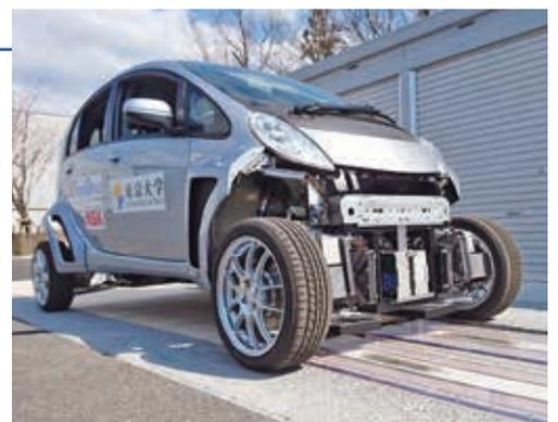
路面に埋められたコイルからインホイールモータへ走行中にワイヤレス給電できる電気自動車
