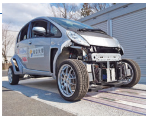
路面に埋められたコイルからインホイールモータへ 走行中にワイヤレス給電できる電気自動車
