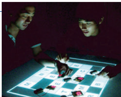
画素単位での可視光通信を実現する テーブル型ディスプレイ「EmiTable」
