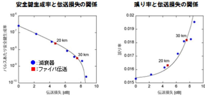
**RRDPSプロトコルの原理確認実験に成功 (安全鍵生成を初めて実現)**
