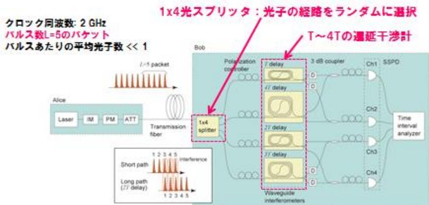
覚醒光子を用いて $T \sim 4T$ の遅延干渉計をランダムに選択する仕組みを実装
