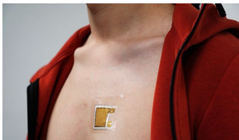
図1 開発した柔らかい音響センサーの写真。ナノファイバーを用いているために通気性がある。
