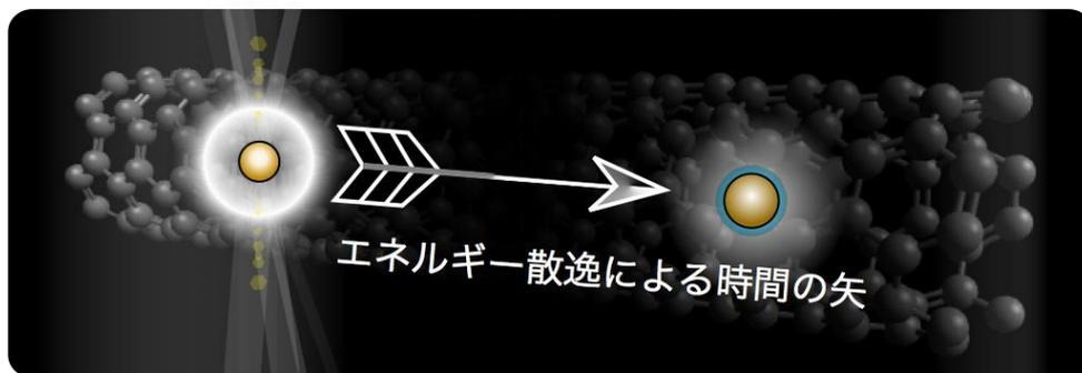
図 1：太陽光で励起されたカーボンナノチューブ上の電子の寿命がエネルギー散逸により伸びる原理の模式図
