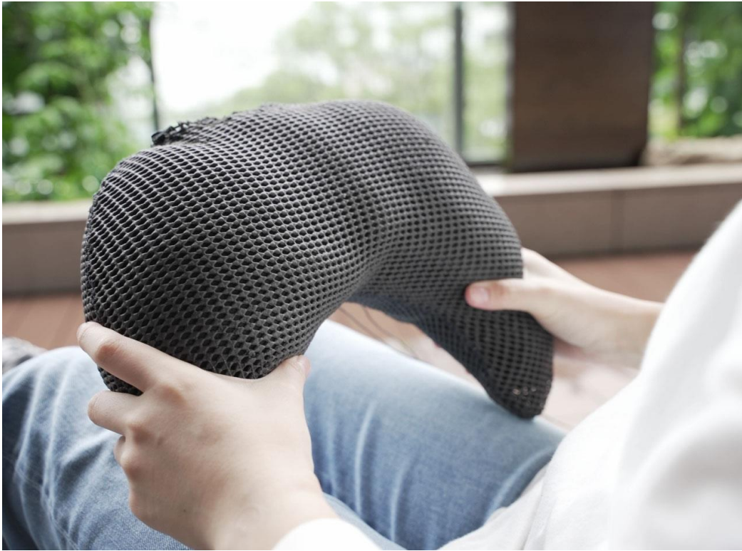
図 2. クッション型のやわらかいコントローラ。握る位置と強さで操縦を行う。
