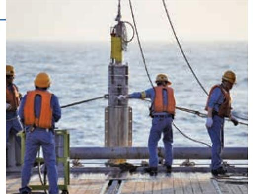
南鳥島レアアース泥のピストンコアラーによる探査
